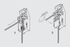
Die neu entwickelte Schnurbremse gewährleistet eine sichere Funktion. A: Abdeckung öffnen.
